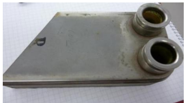
図 18 熱交換器（プレート式）の例（品川八潮団地地区の熱供給先の家庭での利用例）
