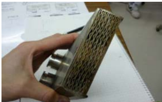
図 18 熱交換器（プレート式）の例（品川八潮団地地区の熱供給先の家庭での利用例）
