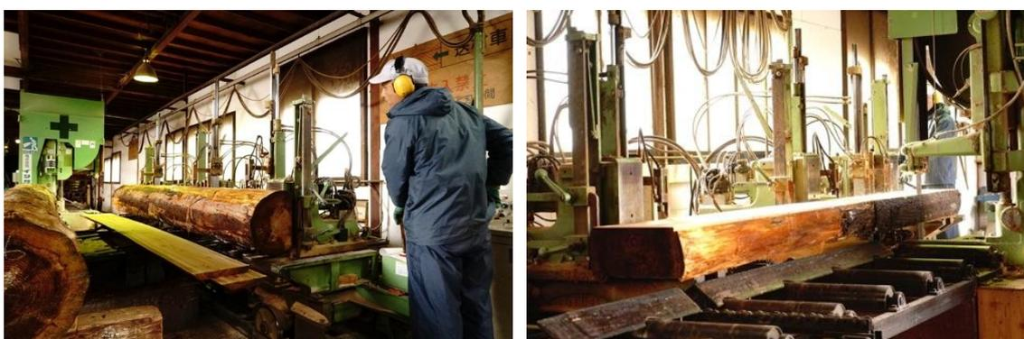
図 17 シングル台車での製材の様子
